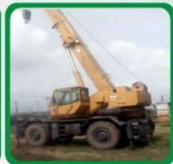
40 TON CAT CRANE
