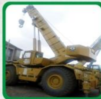
80 TON CAT CRANE
